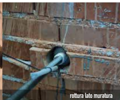
rottura per sfilamento bulbo di malta
